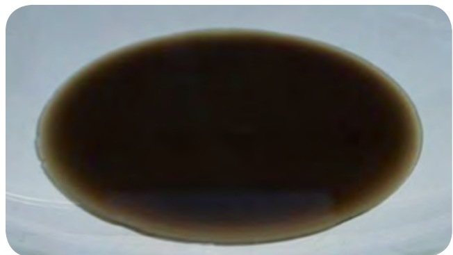
Abbildung 29 und 30: Vergleich von Überschussschlamm (links) und Hydrolysat (rechts), jeweils mit 5% Trockenrückstand (TR) Quelle: CUTEF Forschungszentrum für Rohstoffsicherung und Ressourceneffizienz der Technischen Universität Clausthal
